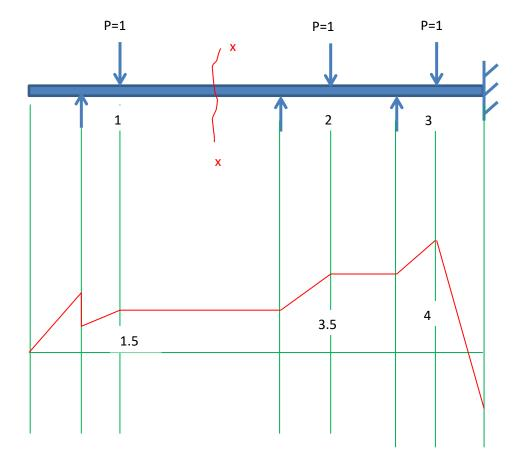
لنفرض أن هذا الخط البياني يمثل قيم قوق القص عند المقطع س-س فنقرأه بالشكل التالي أن قيمة قوة القص في هذا المقطع تساوي 1.5 حينما يكون الحمل الذي يساوي 1 عند النقطة 2 وهكذا يكون الحمل على الجسريقيمة 1 عند النقطة 1 وتكون قيمة قوة القص 3.5 في هذا المقطع حينما يكون الحمل الذي يساوي 1 عند النقطة 2 وهكذا
