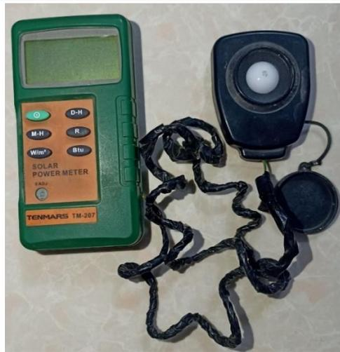
Fig. 4.17 solar power meter
