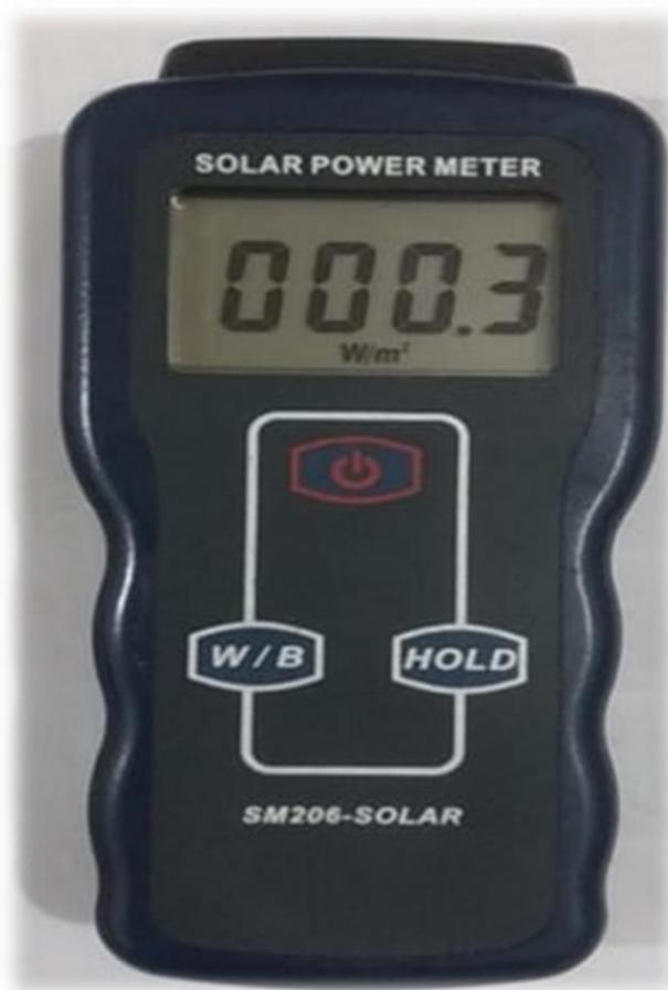
**Figure (4.8)** Solar Power Meter
