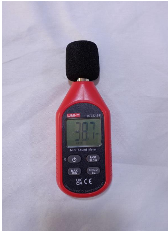
Figure 3.22 Mini Sound Level Meter
